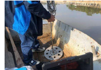
รูปที่ 6 ตรวจสอบความถูกต้องของเครื่องหยั่งน้ำ
